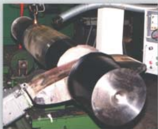
ložiskové plochy rozdávacích lopatiek vodných turbín
