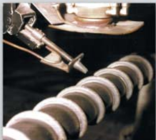
závitnicové podávače pre lisovanie a vulkanizáciu gumy
