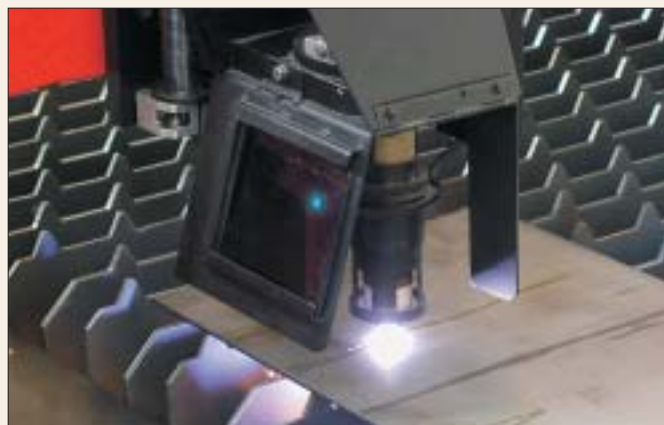
Prvá fáza rezania na plazmovom rezacom stroji s počítačovým riadením
