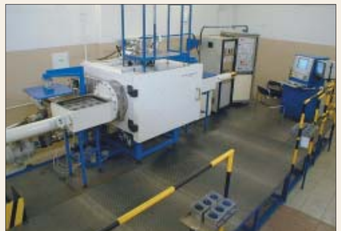
Jednoučelové elektrónovo-lúčové zväracie zariadenie EZ-ZH2 na zváranie výmeníkov tepla z hliníkovej zliatiny
