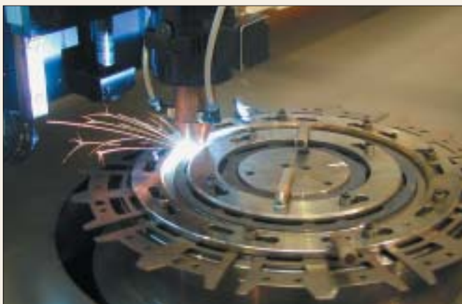
Zváranie spojkovvej lamely laserom
