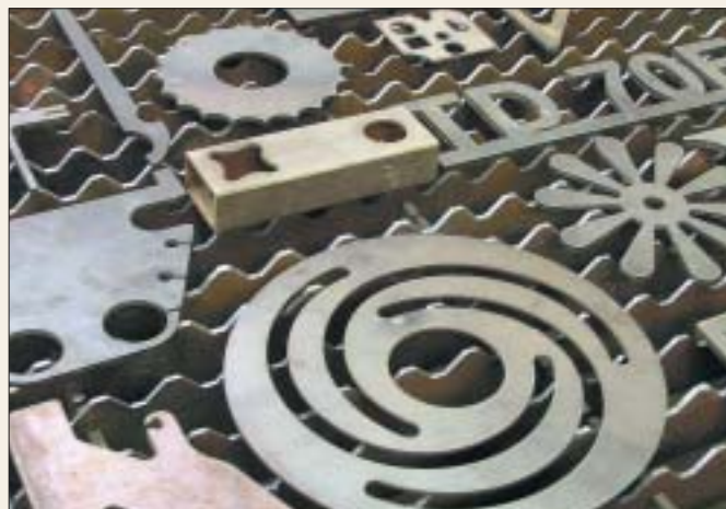
Súčiastky rezané plazmou môžu byť tvarovo zložité s veľkou presnosťou rezu
