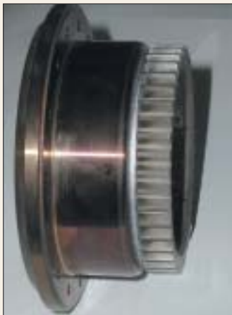
Detail zvaru medzi ozubeným kolesom a prírubou
