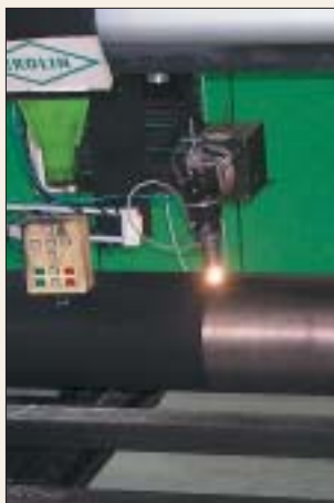
Laserové kalenie valcov na výrobu mikroténovej fólie
