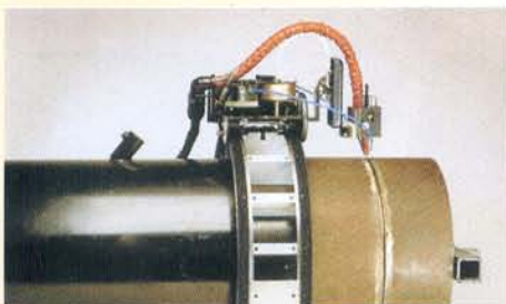
T-hlava, určená pre orbitálne zvarovanie rúr väčších priemerov a hrúbok. Na jednom prstenci je možné, pre zvýšenie produktivity, použiť až dve hlavy súčasne.
