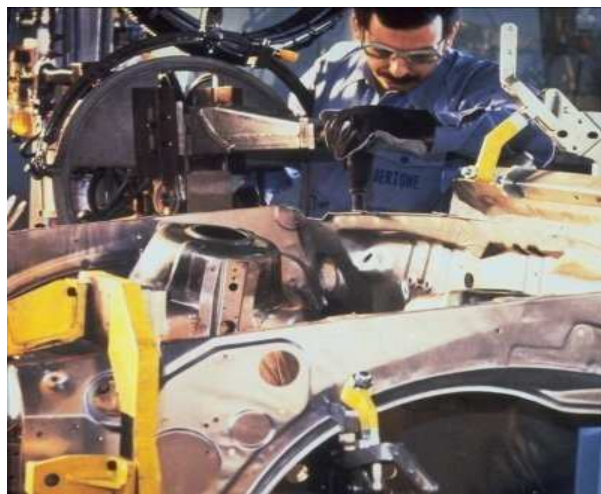
Aplikácia adhezív pri kompletizácii automobilu
